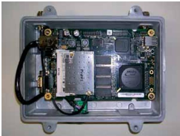
Il Vehicular Manager offre al sistema a bordo del veicolo le funzioni di roaming tipicamente implementate in un client WiFi, utilizzando le due interfacce wireless in modo ottimale per gestire la connessione verso l'infrastruttura ed al tempo stesso per cercare i nuovi nodi a cui connettersi, senza dover attendere l'interruzione del collegamento verso l'infrastruttura fissa. È importante osservare che tale software si basa sul paradigma dei
