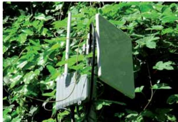
► Prima tratta radio della rete mesh VICSUM installata lungo la tramvia a dentiera "Sassi-Superga": il collegamento è tra l'apparato a sinistra e un analogo apparato installato sulla pensilina bianca visibile a valle.
