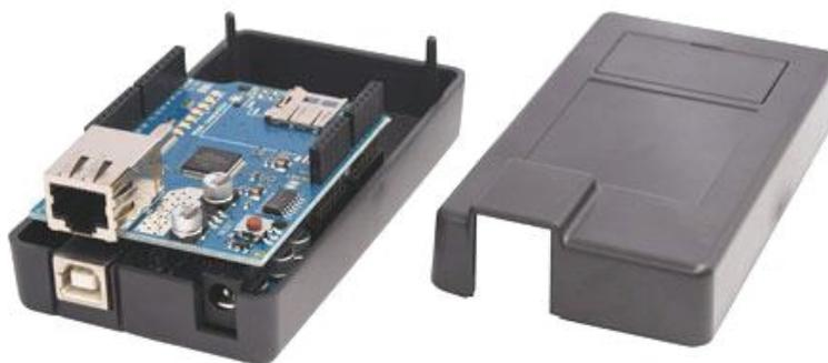
Figura 3 - Eco Tail come risulta montato nel box.
