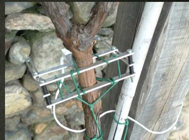
Dendrometro per stima stress idrico su singola pianta
