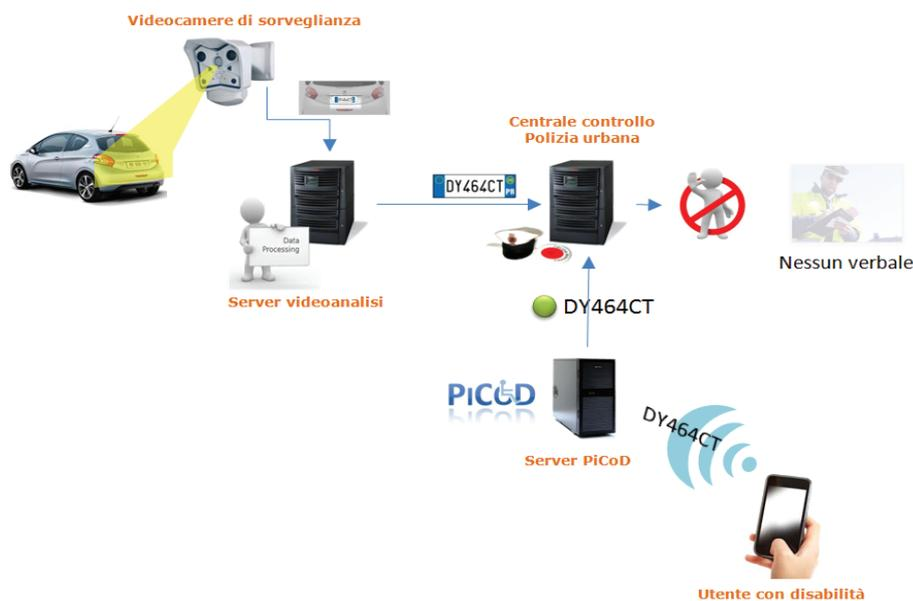
Figura 1 - L'architettura di funzionamento
